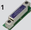
Schmalbandiges Roofing-Filter zur wirksamen Unterdrückung von Störungen in der unmittelbaren Nähe eines Nutzsignals
