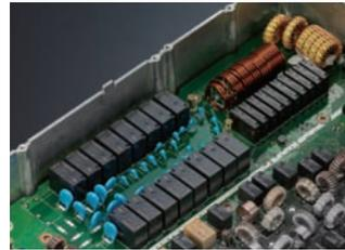
Der Tuner ist ein Preset-Typ, der auch beim Empfang genutzt werden kann und sämtliche Amateurbänder zwischen 1,8 und 70 MHz abdeckt. Seine Speicher, die man über das Menü für jedes Band ein- und ausschalten kann, und die bewährten Relais erlauben schnelle Frequenzwechsel, was zum Beispiel im Contest sehr wichtig ist.
