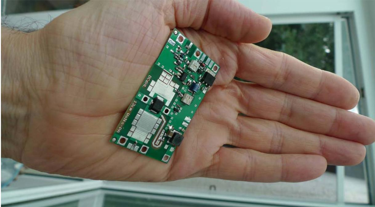
**Bild 4** Hier ist die erste kommerziell gefertigte noch per Handlötung bestückte Platine zu sehen.
