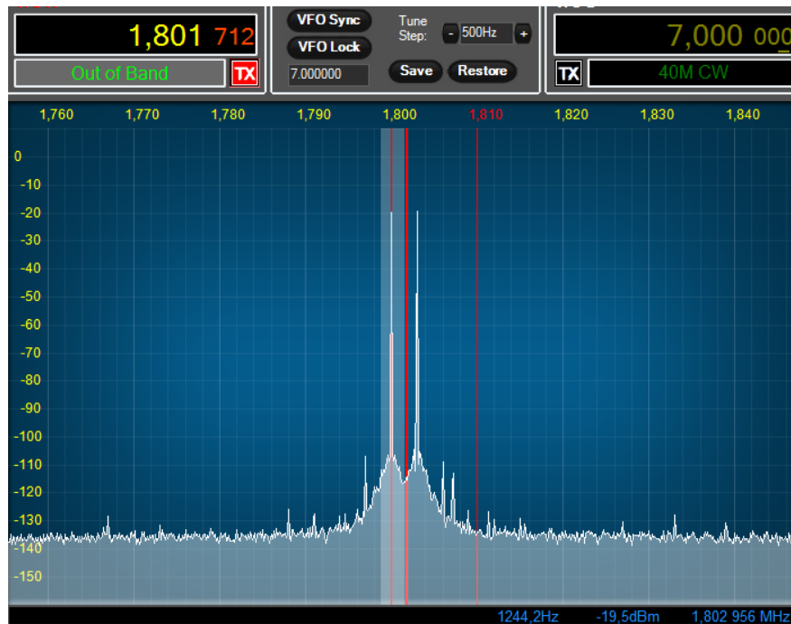
Bild 4 zeigt wieder das gute Verhalten des Hermes bei hohen Pegeln kurz vor der Aussteuergrenze diesmal bei niedriger Empfangsfrequenz.
