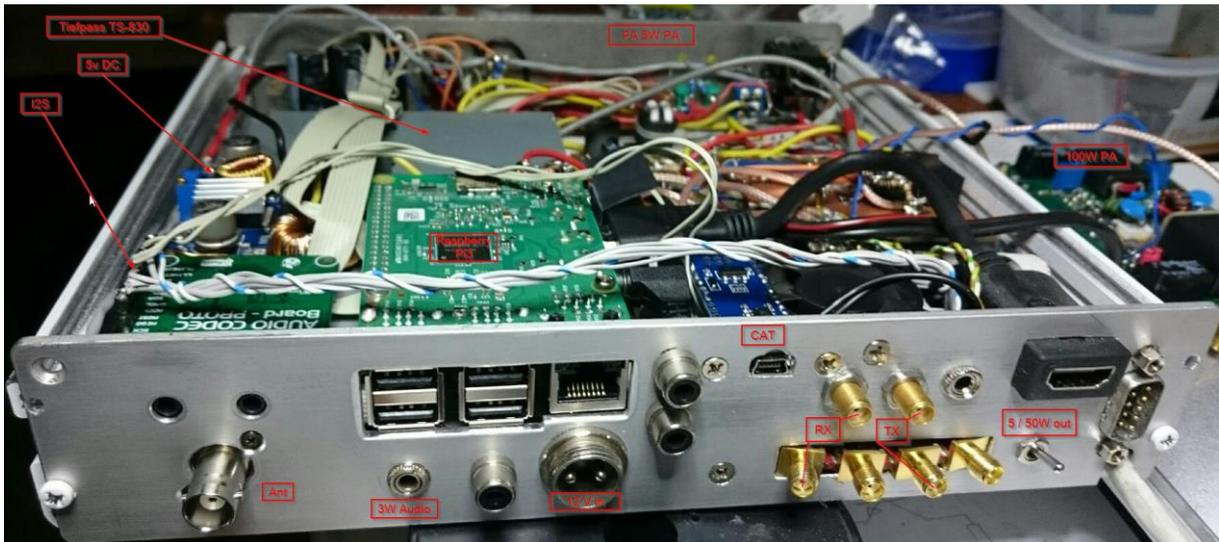
Die Portabel- Betrieb- Bedienung erfolgt über ein 8" Tablet per VNC, wobei der RasbPi als Accesspoint dient. (auch mit geschlossenem Gehäusedeckel)
