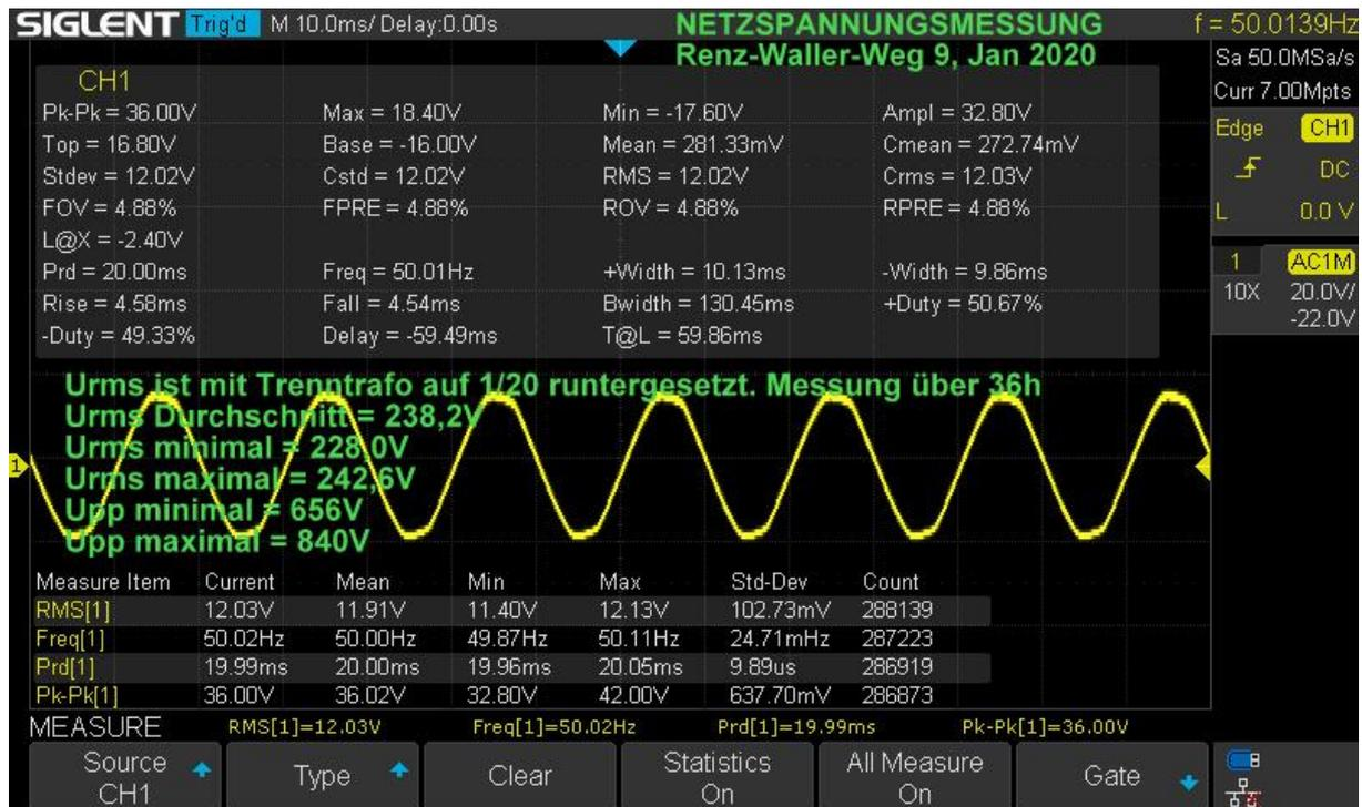
Das Bild ist ein Screenshot von einem digitalen Speicher-Oscilloscope von SIGLENT (2x 200MHz, 1 Gigasample/s). Das habe ich 36h lang über einen Trafo mit Übersetzungsverhältnis 1/20 an die Netzspannung gehängt. Das Scope schreibt 2-3x pro Sekunde alle möglichen Werte mit. Oben im Bildschirm sieht man alle Werte, unten nur Effektivwert (RMS), Durchschnitt (mean), Frequenz, Periodendauer (PRD).
