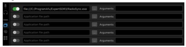
Zum automatischen Starten und Beenden von weiteren Programmen mit ExpertSDR, hier z.B. **RadioSync** zur Emulation der VAC - und CAT - Schnittstellen.
