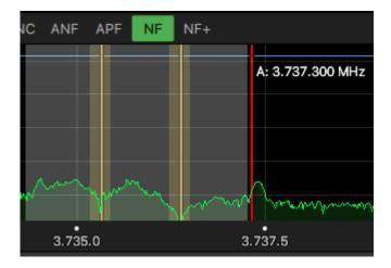
Mit **NF+** können bis zu 8 variable Notch-Filter hinzugefügt werden. Position und Breite der Notchfilter werden mit der linken Maustaste eingestellt, funktioniert wie beim RX-Filter.
