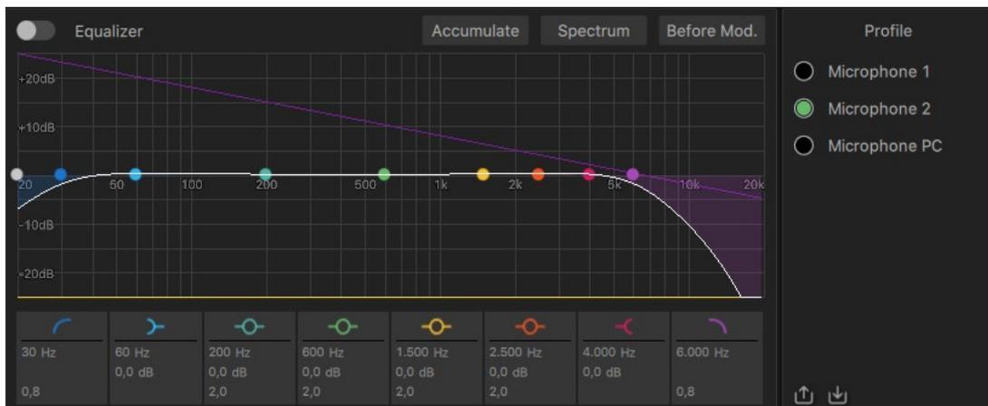
Für jeden Mikrofonkanal stehen separate Equalizer-Einstellungen zur Verfügung. Pegel, Frequenz und Bandbreite sind auch hier frei einstellbar, die weiße Linie zeigt die finale Filterkurve. Zusätzlich kann für das Monitoring **vor** oder **hinter** dem Modulator gewählt werden.
