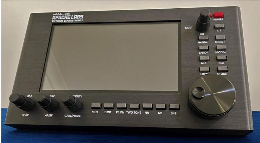
**Abb. 10.13:** Ein Bild des Controller2 (Bild mit freundlicher Genehmigung von Apache Labs).
