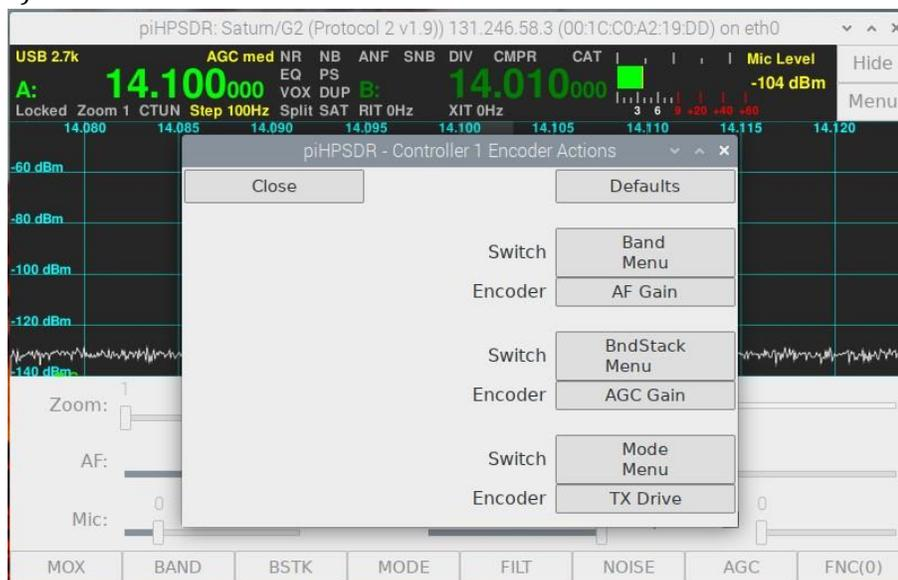
Abb. 10.16: Das Encoder-Menü für Controller1
