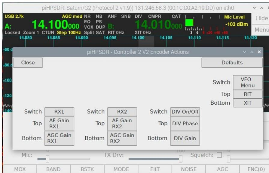
**Abb. 10.14:** Das Encoder-Menü für Controller2
