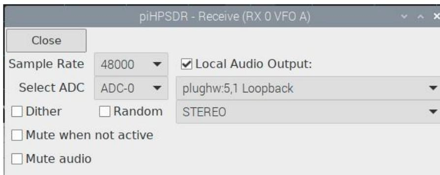
**Abb. F.1:** Einstellungen des RX-Menüs für die Verwendung von Loopback mit ALSA.
