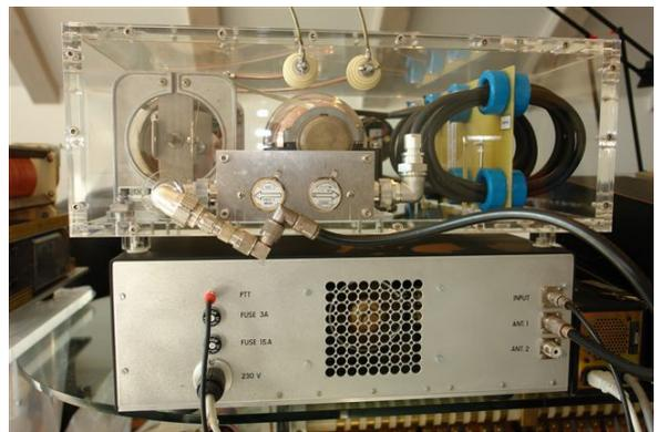
Abb. 20: 4 Kg schweres Netzfilter für 3 x 400V
